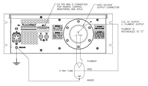
TYPICAL OPERATING SETUP/FILAMENT CONTROLLED EMISSION LOOP
